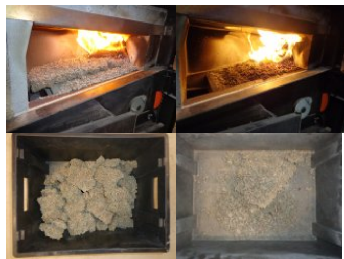
À gauche, foyer chaudière laboratoire, déchets verts « tout venant » - taux de cendres de 23%. À droite, déchets verts criblés - taux de cendres de 4%. Dessous les bacs de décendrage correspondants, photos RAGT Energie
